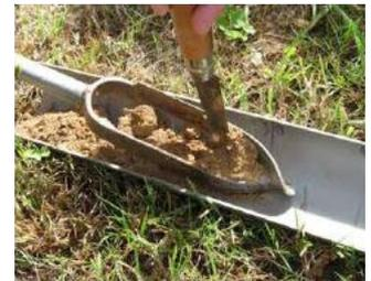
G. Déposer de nouveau la carotte dans la gouttière. Le dépôt est effectué suite à la mesure dans le trou de la profondeur du sondage. Il est préconisé de mesurer directement dans le trou à l'aide d'un mètre ruban afin de positionner correctement le prélèvement dans la gouttière.
