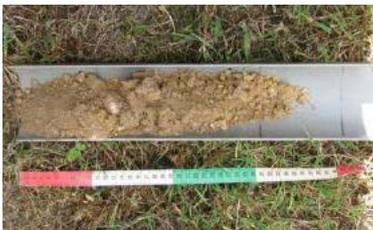
H. Répéter les opération A à C puis F à G jusqu'à ce qu'on ne puisse plus creuser (roche atteinte, cailloux empêchant d'avancer, 60 cm atteints). Une fois le sondage réalisé, nous disposons, dans la gouttière, d'une vision d'ensemble du profil reconstitué. Dans le protocole, il est recommandé de creuser jusqu'à 60 cm de fond. Lorsque vous effectuez les premiers sondages sur un site non connu du point de vue pédologique, il est recommandé de le faire plus profond (120 cm).
