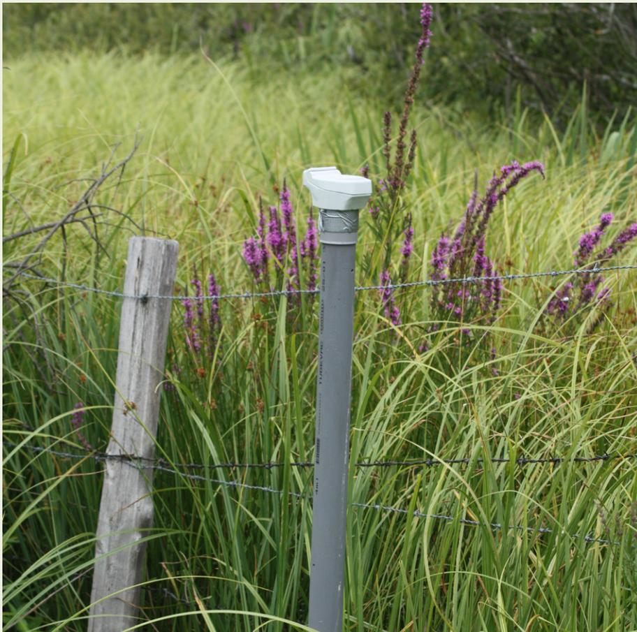
Piezomètre équipé d'une sonde de mesure automatique
