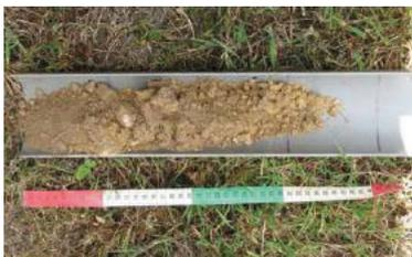
**H.** Répéter les opérations A à C puis F à G jusqu'à ce qu'on ne puisse plus creuser (roche atteinte, cailloux empêchant d'avancer, 60 cm atteints). Une fois le sondage réalisé, nous disposons, dans la gouttière, d'une vision d'ensemble du profil reconstitué. Dans le protocole, il est recommandé de creuser jusqu'à 60 cm de fond. Lorsque vous effectuez les premiers sondages sur un site non connu du point de vue pédologique, il est recommandé de le faire plus profond (120 cm).
