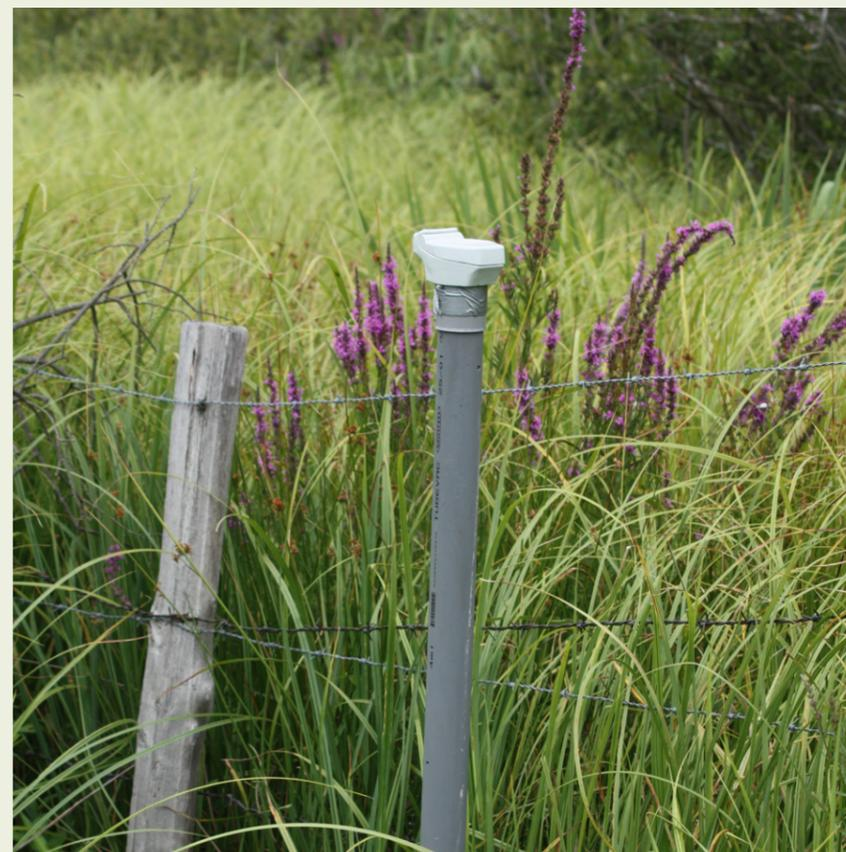
Piezomètre équipé d'une sonde de mesure automatique
