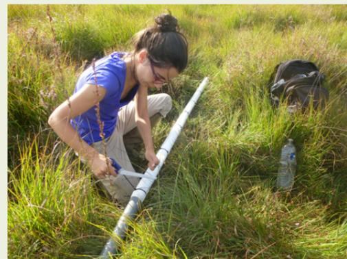
tériel du sol de rentrer dans le tube (colmatage). Les tubes dépassent du sol pour faciliter leur repérage au milieu de la végétation. Une marque est réalisée au niveau du sol pour matérialiser le niveau 0 et vérifier que le piézomètre ne bouge pas au fil du temps. Les tubes sont équipés de sondes à capteur de pression permettant l'enregistrement automatique des valeurs à un pas de temps défini.
