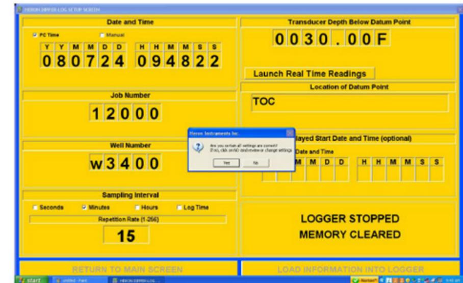
18-Saisir la profondeur de la sonde sous le point de référence (Transducer Depth below Datum) dans l'unité indiquée (F=feet, M= mètre).
